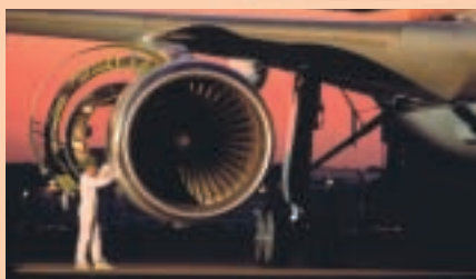
Technicien vérifiant un réacteur d'A310
