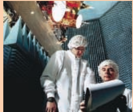
Envisat est placé dans une chambre anéchoïde d'Astrium afin de vérifier la compatibilité des différentes fréquences radio
